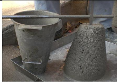
**Fig. 2: Slump Test**
